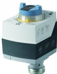
Vannes modèles VVG44 et VXG44. Montage horizontal à vertical. Force de positionnement : 400 N. Dérogation manuelle. IP 54. 230 V. Signal de commande 3 points. Temps de course 120 sec.
