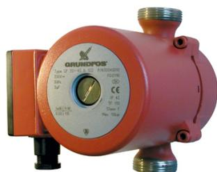
Circulateur monovitesse domestique pour bouclage E.C.S. Certification ACS. Indice de protection IP 42. Classe d'isolation F. Pression maximale de service 10 bar. Débit jusqu'à 4 m<sup>3</sup>/h. Température du liquide +2 °C à +110 °C (+60 °C maxi pour ECS). Entraxe 150 mm.
