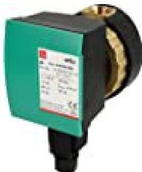
Bouclage ECS. Pompe de circulation pour eau potable avec raccordement à visser et moteur synchronisé. Système de circulation de l'eau potable utilisé dans l'industrie et le bâtiment. Tension alimentation 230V. Débit 0,4 M3/h. Entraxe 138 mm. Diamètre des raccords 15x21. Pression max 10 bars. Certifié ACS.
