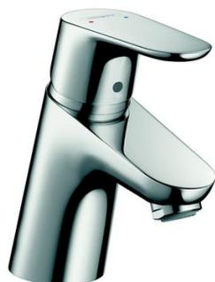
Cartouche céramique à deux vitesses (butée à 50%). CoolStart : démarrage en eau froide en position de poignée centrée. Mousseur QuickClean. Garniture de vidage 1"1/4. Tirette excentrée. Raccordement flexibles G 3/8". NF. Hauteur totale 133 mm. Hauteur sous bec : 53 mm.
