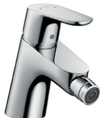
Mitigeur mécanique de bidet C2 avec cartouche à 2 vitesses, tirette et vidage. Longueur du bec : 126 mm. Hauteur du bec : 54 mm. Avec bec déverseur. Mousseur sur rotule avec pivot. Jet Normal. Débit maximal à 3 bars : 8,3 U/min. Limiteur de température réglable. Convient au chauffe-eau instantané. Garniture de vidage métallique. E0, C2, A2, U3.
