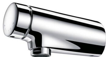
Déclenchement souple. Temporisation ~7 secondes. Débit pré-réglé à 3 l/min à 3 bar, ajustable de 1,4 à 6 l/min. Aérateur antitartre. Corps en laiton massif chromé M1/2. Livré avec un repère bleu et rouge. Adapté aux PMR. Garantie 10 ans.
