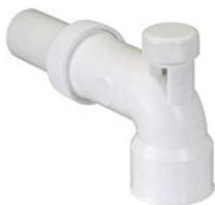
Garde d'eau 50 mm. Réglable de 165 à 215 mm d'entraxe. Entrée mâle Ø 40. Coude équipé d'une prise anti-vide.
