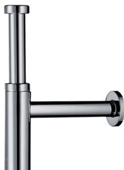
Siphon design chromé 1 1/4" pour lavabo. Tube d'entrée réglable de 60 à 165 mm. Tube de sortie 330 mm. Rosace Ø 72 mm.
