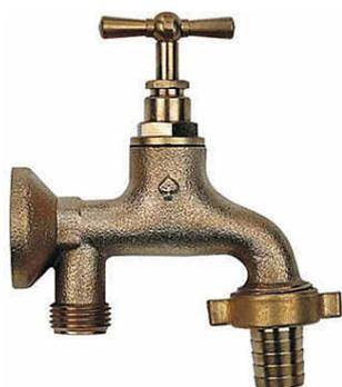
Robinet de puisage en laiton brossé avec raccord au nez. Applique de fixation murale incorporée. Pose en applique. Filetage entrée : 15x21 mm - Filetage sortie : 20x27 mm et nez : 15x21 mm. Raccord nez : Ø 50,8 - Diamètre du tuyau 14.
