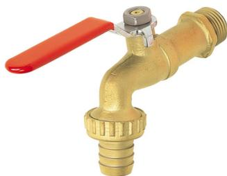
Robinet de puisage à boisseau sphérique - Poignée acier plate rouge - Corps laiton - PN 16 - Corps brossé ou nickelé - Presse-étoupe PTFE - TS : 0 à + 60 °C.
