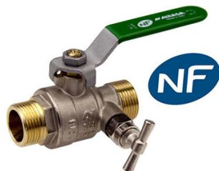
Garantie 10 ans. Corps laiton CW617N nickelé et interne brossé. Sphère laiton chromé. Presse étoupe PTFE + Joint torique EPDM. Passage intégral. Axe injectable. Poignée anti corrosion. Bille pleine et percée jusqu'au DN 1 1/2 (évite la stagnation d'eau entre le corps et la sphère). ACS et conforme 4MS.
