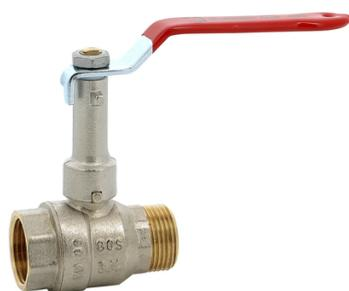
Réseaux d'adduction et de distribution d'eau. Température mini admissible Ts : - 10°C. Température maxi admissible Ts : + 120°C. Pressions maxi admissibles. Ps : 30 bars jusqu'au DN 1", 20 bars en 1 1/4 et 1 1/2, 16 bars en 2".
