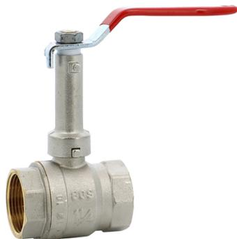
Réseaux d'adduction et de distribution d'eau. Température mini admissible Ts : - 10°C. Température maxi admissible Ts : + 120°C. Pressions maxi admissibles. Ps : 30 bars jusqu'au DN 1", 20 bars en 1 1/4 et 1 1/2, 16 bars en 2".
