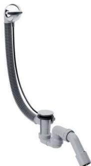
Compatible avec pour baignoires standards. Vis de raccordement PE 1"1/2 x 40/50 mm. Longueur du câble Bowden 520 mm. Trappe anti-odeur - hauteur du reflux 50 mm. NF\_375-M1-23-2.
