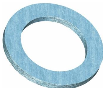
Remplace joint amiante caoutchouc, Hydrocarbure simple, eau +/- 180°C et 100 bars. Les valeurs de températures et de pression ne sont pas associées.
