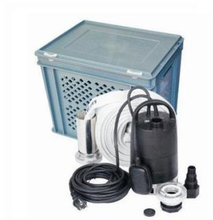
Le box comprend une pompe Unilift CC7 équipée d'un accouplement Storz, une boîte filtrante multifonctionnelle, 15 m de tuyau flexible équipé d'une gaine de protection, un connecteur Unilift CC supplémentaire et un flotteur à contact. Hauteur de refoulement max 7 m, débit max. 10 m<sup>3</sup>/h, température du liquide pompé entre 0°C et +40°C.
