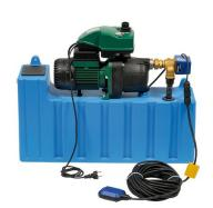
Ensemble complet et prémonté. En cas de manque d?eau dans la cuve enterrée, commute automatiquement sur l?eau de ville grâce à l?électrovanne. Comprend un réservoir disconnecteur entièrement équipé 25L, un Active Jetcom 102 M, un électrovanne 3 voies, un flotteur avec contrepoids (longueur 20 mètres). Installation au sol ou murale.
