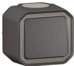
Poussoir NO 10A - Connexion rapide sans outil avec repérage couleur. Produit complet, prêt à être installé en saillie. IP55 : protégé contre les poussières et les projections d'eau à la lance de toutes directions. IK08 : résistance à un choc de 5 joules.
