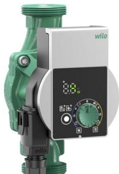
Pompe à haut rendement Wilo-Yonos PICO, à variation électronique. Pompe de circulation sans entretien à rotor noyé avec raccord fileté, moteur synchrone auto-protégé avec technologie ECM et régulateur de puissance électronique intégré pour régulation de la pression différentielle. Utilisable pour toutes les applications de chauffage et de climatisation. Mode de régulation sélectionnable selon l'application radiateurs/plancher chauffant.
