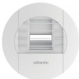
Permet un débit de 10 à 40 m<sup>3</sup>/h. Peut accéder à un débit de pointe de 90 m<sup>3</sup>/h par bouton poussoir à commander séparément. Diamètre de la bouche : 125 mm. Plage de débit : 10 à 40 m<sup>3</sup>/h. Débit de pointe : 90 m<sup>3</sup>/h.
