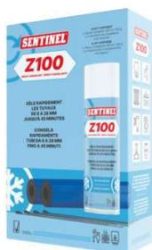
Gèle les tuyaux de 8 à 28 mm. Spray congelant à action rapide : formation de blocs de glace en 5 min. Génère des blocs de glace qui tiennent jusqu'à 45 minutes. Compatible avec les tuyaux en cuivre, plastique, plomb, acier et fer.
