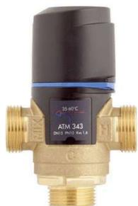
Fonction anti-brûlure et anti calcaire. Bouton de réglage très lisible avec échelle double en indice et °C. Capot de protection pour éviter toute modification accidentelle de la température de consigne. Capot de protection avec fenêtre de lecture du réglage et possibilité d'être plombé. Corps en laiton DZR haute qualité, basse teneur en plomb, résistant à la dézincification. Double ressort pour la protection contre les surchauffes de l'élément thermostatique.
