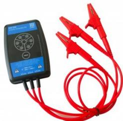
Contrôleur de cartes inverter pour systèmes de climatisations, de pompes à chaleurs et de réfrigérations. ICK-250 est un outil de diagnostic très fiable et performant qui permet en quelques minutes de déterminer si le défaut provient de la carte inverter ou par élimination du compresseur. Livré avec câbles et connectiques, dans un étui de transport robuste. Outil indispensable pour tous les pros du génie climatique et de la maintenance.
