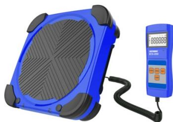
Capacité maximale 100 kg. Précision: 0,05% de la lecture + 10 g. Résolution: 5 g. Plateau de grande dimension 27 x 27 cm pour une stabilité maximale. Très légère seulement 3,6 kg et peu encombrante grâce à son logement qui permet de ranger et protéger la télécommande lors des manipulations.
