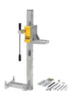
Colonne de carottage en tube carré Ø50 mm anti-flexion et anti-torsion, acier de précision éroui, tolérances minimales, pour guidage sans vibrations du chariot d?avance. Avec outils comprenant clé six pans mâle de 6, clé plate de 19 et 30 et set de fixation comprenant 2 chevilles écarteurs M 12 pour maçonnerie, 10 chevilles d?ancrage M12 pour béton, chasse pour cheville d?ancrage M12, tige fileté à moletage M12 × 65, écrou à serrage rapide, rondelle. Dans boîte carton.
