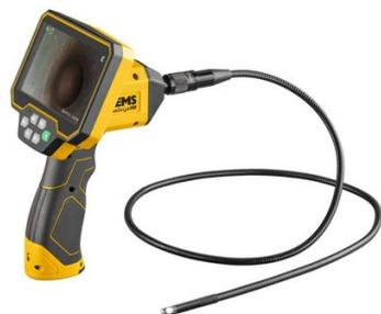
Caméra pour inspecter les gaines, cavités et autres espaces réduits. Grand écran TFT LCD 5" haute résolution. Etanche à la poussière et à l'immersion temporaire dans l'eau. Câble de poussée semi-rigide 1 m. Enregistrement photo et vidéo. Zoom x4. Double tête de caméra 180°/90°. Fonctionnement sur batterie (autonomie 5 heures) ou sur secteur. Livrée en coffret plastique avec carte MicroSD 32 Go, câble de recharge USB.
