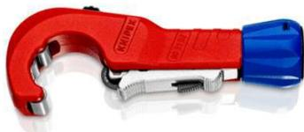
Verrouillage en butée rapide à une seule main QuickLock : coulisser, couper - terminé ! Permet une utilisation rapide et précise de la molette de coupe sur différents diamètres de tubes. Coupe facile grâce aux roulements à aiguilles au niveau de la molette de coupe et des rouleaux de guidage. Coupe des tubes de Ø 6 - 35 mm (1/4" - 1 3/8") avec épaisseur de paroi jusqu'à 2 mm. Molette de coupe en acier spécial à roulement à billes haute qualité
