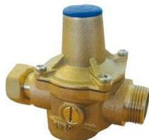
Normalisé NF EN 1567. Fonctionne en toutes positions. Pression amont maxi 16 bar. Pression aval réglable de 1 à 5,5 bar. Préréglé d'usine à 3 bar. Débit 2000 l/h en 15/21, 2800 l/h en 20/27 pour une perte de charge de 1 bar. Bouchon 1/4" de chaque côté permettant la pose d'un manomètre. Corps bronze.
