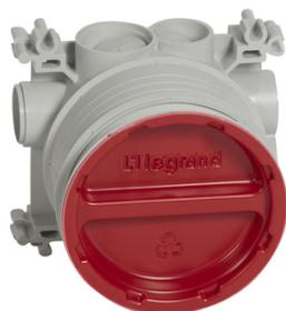
Boîte d'encastrement simple. A associer pour prises de sol multiples. 2 possibilités d'installation en multipostes : entraxe 86 mm pour platine double ou platines simple poste carrées associées, entraxe 95mm pour platines simples carrées ourondes espacées. Pour béton. Pour chape hauteur de 50 mm à 80 mm.
