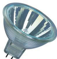
Lampe halogène TBT. Puissance restituée entre 25 et 50W. Température de couleur 2950 K - Durée de vie 2 000h- Culot GU 5.3
