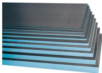
Le panneau de construction wedi se compose d'un noyau bleu en mousse dure de polystyrène extrudé. La mousse dure est armée sur les deux faces d'un tissu en fibres de verre (avec un apprêt résistant aux alcalis) et enduite d'un mortier plastifié. Le panneau de construction wedi peut être installé sur presque tous les supports, il est étanche à l'eau, isolant thermique, modulable, léger, stable, facile et rapide à travailler.
