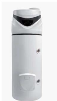
Installation au sol. Cuve en acier émaillé. Double protection contre la corrosion : une anode titane + une anode magnésium. Compatible aussi avec le fluide frigorigène R513A. Raccords diélectriques non fournis. A + HC HP compatible RV
