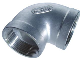
Raccord en inox ASTM A351 CF8M. Taraudage cylindrique BSP. Fabrication par procédé de cire perdue. Température Mini : -25°C. Température Maxi : +180°C. Pression Maxi : 20 Bars
