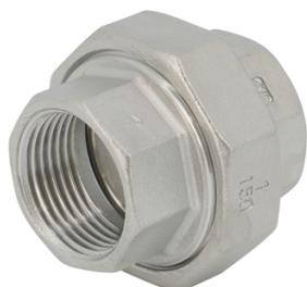
Raccord en inox ASTM A351 CF8M à portée conique. Taraudage cylindrique BSP. Fabrication par procédé de ??cire perdue??. Température Mini : -25°C. Température Maxi : +180°C. Pression Maxi : 20 Bars.
