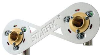
Permet la fixation et le raccordement de robinetterie avec raccords à sertir sur une plaque de plâtre de 13 mm minimum. Entraxe de 150 mm.
