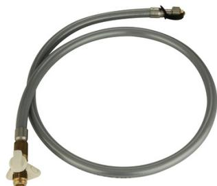
Pression maximale d'utilisation : 37 mbar. Robinet avec obturateur automatique intégré. Tuyau flexible inox annelé renforcé par une tresse en fil d'acier inoxydable, équipé d'un joint. Entrée : mâle G 1/2". Sortie : écrou prisonnier tournant femelle G 1/2" avec bouchon. Classe de température : - 5°C / + 60°C.
