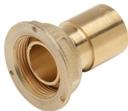
Pression maximale d'utilisation : 500 mbar. Écrou prisonnier tournant femelle plombable et douille à Joint Plat Compteur à braser sur tube cuivre ou sortie acier. Livré avec 1 joint. Version disponible avec oreille de fixation.
