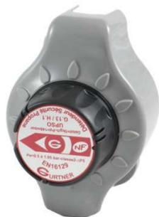
Se pose après la première détente. 3 fonctions : Robinet d'arrêt - détente - sécurité (coupure du débit en cas de chute de pression amont). Raccord MM 20x150. Le modèle 044109 est en plus muni d'une sécurité en cas d'excès de débit.
