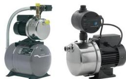
Pompe centrifuge auto-amorçante pour une adaptation au réseau de tuyauterie local avec une excellente capacité d'aspiration pour de l'eau de 0 à 40 °C. Conception robuste et résistante à la corrosion - corps en acier inoxydable - roue en composite - peinture par électrophorèse - scellés et graissés à vie. Petite et compacte avec une poignée de lavage avec une hauteur d'aspiration jusqu'à 8 mètres. La pompe peut gérer un mélange d'air et de liquide.
