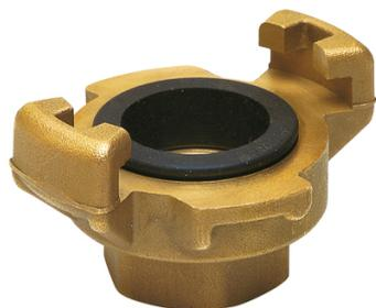
Raccord express en laiton avec joint NBR monté, modèle femelle, entre-griffes 41 millimètres, taraudé et fileté BSP pour eau et air comprimé.
