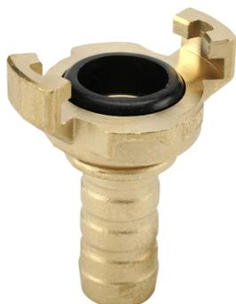
Raccord express en laiton avec joint NBR monté, modèle cannelé à collerette, entre-griffes 41 millimètres, taraudé et fileté BSP pour eau et air comprimé
