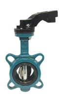
Robinet à papillon à oreilles de centrage, avec corps fonte GL, papillon en fonte GS et manchette EPDM, platine ISO 5211, double étanchéité PTFE, pour eau froide et eau chaude.
