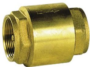
Clapet de non-retour ACS à double guidage laiton 4MS pour les réseaux d'eau potable, chauffage, air comprimé et fioul. Le corps est en laiton CW617N-4MS, l'obturateur est en laiton et l'étanchéité est assurée par un joint plat NBR garantissant une excellente étanchéité haute / basse pression. Système à double guidage axial et latéral assurant un centrage parfait de l'obturateur sur le siège. Le ressort de rappel en inox 302 permettant un montage toutes positions.
