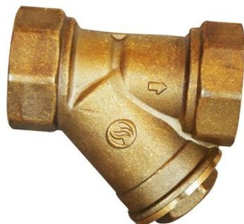
Filtre à tamis en Y laiton 4MS pour les réseaux d'adduction et de distribution d'eau. Filtration de 850 avec tamis en inox 304 démontable. L'étanchéité est assurée par un joint torique EPDM. Compatible avec les réseaux d'eau potable grâce à l'attestation de conformité sanitaire (ACS).
