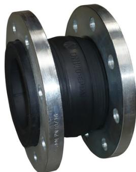
Compensateur de dilatation, élastomère, à brides en acier galvanisé, à simple soufflet EPDM, câble acier trempé, raccordement à brides PN10 pour réseaux d'adduction et de distribution d'eau
