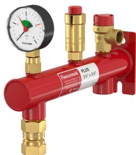
Manomètre Flexcon (0 - 4 bar) avec clapet d'isolement, Flexvent 3/8 à Flotteur avec clapet d'isolement, Soupape de sécurité 1/2 - 3 bar, Flexfast groupe de raccordement-isolation, Set de montage.
