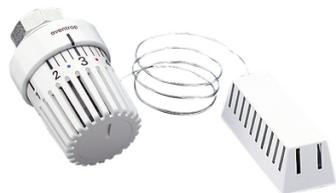
Avec bulbe à distance. Limitation et blocage d'une valeur nominale individuelle. Avec pastille de mémoire. Avec fonction hors-gel. Testé et approuvé selon EN 215. Convient pour robinets avec raccordement fileté M 30 x 1,5 et robinetterie intégrée avec raccordement fileté M 30 x 1,5.
