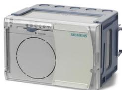
Régulation de la température de départ en fonction de la température extérieure, avec ou sans compensation de la température ambiante. Action progressive sur vanne avec moteur 2 points ou thermique ou sur brûleur tout ou rien. Pente de chauffe réglable. Modèle RVP 211 : avec production d'eau chaude sanitaire. Avec boucle de régulation ECS soit par pompe de charge, soit par la vanne mélangeuse (prévoir sonde QPA21.3). Vendu sans l'horloge analogique.
