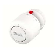
Plage de réglage 5 à 26°. RA 2990 : Bulbe incorporé, Vt 0.5K, temps de réaction 10 min. RA 2992 : Bulbe à distance (0 à 2 m), temps de réaction 8 min.
