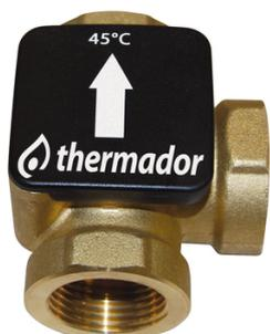
La vanne assure un recyclage vers le foyer tant que la température de consigne n'est pas atteinte. Température maxi. De fonctionnement : 110°C. Pression maxi. de fonctionnement : 6 bar. Corps de la vanne : laiton FFF 1" ou 1"1/4. Capsule thermostatique intégrée tarages 45°C, 61°C ou 72°C.
